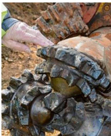
So sieht der Bohrkopf, der bei einer Tiefe von 140 Metern verwendet wird, aus.
